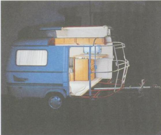
AERO-Bauweise bei den Touring-Modellen durch die legendäre Stahlrohrrahmen-Konstruktion, die leicht, selbsttragend und verrottungsfest ist. GfK-Hubdachschaale und Aluminium-Außenhaut.
